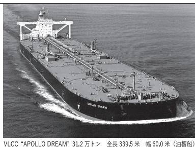
VLCC "APOLLO DREAM" 31.2万トン 全長339.5米 幅60.0米(油槽船)
